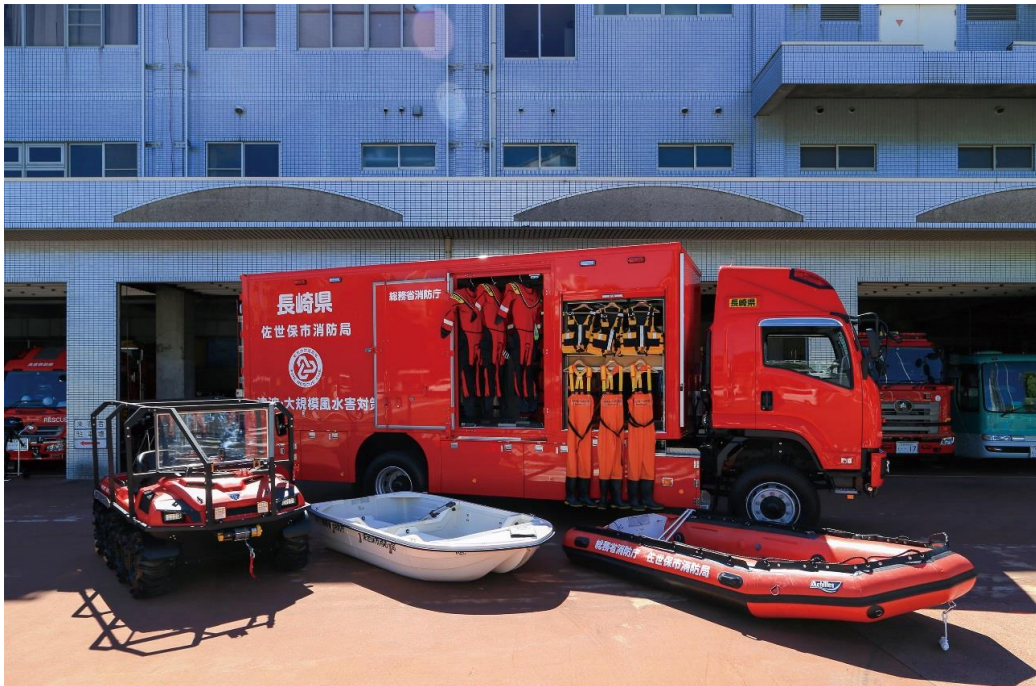
津波・大規模風水害対策車（中央消防署）
